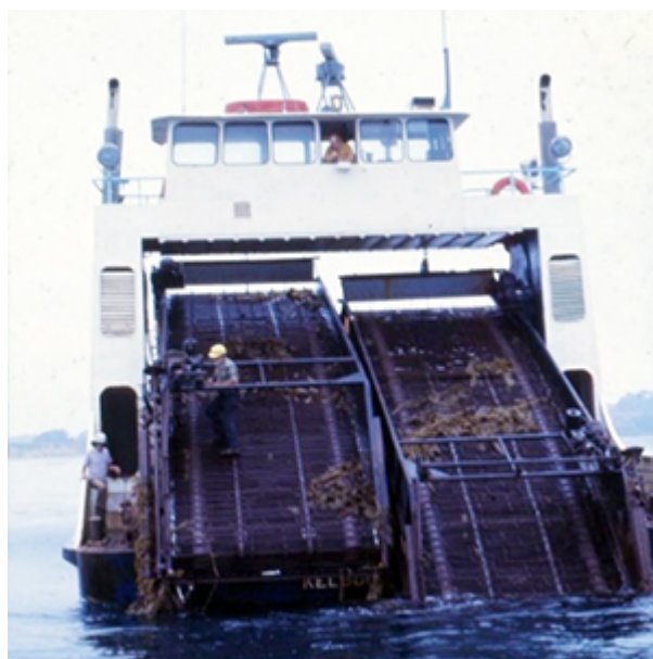
写真4 ジャイアントケルプ刈取り船。船をバックさせながらエスカレーター状の刈取り機でケルプは上方に運ばれる。(カリフォルニア州沖、1977年)
